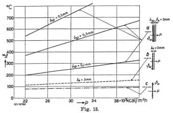
Einfluss der Krustenbildung auf die Heizkörpertemperatur a Spalt + Kruste. b Kruste. c reine Oberfläche.
