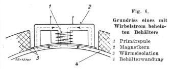
gen die Oberfläche des Bleches hin zunimmt, werden mit Vorteil für hohe Leistungen kupferplattierte Eisenbleche verwendet Die Wärmewirkung solcher Wirbelströme kann je nach Umständen sehr beachtlich sein. Fig. 6 zeigt schematisch die Anwendung einer solchen Heizung in der Praxis.
