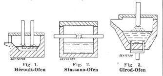
det deshalb vor allem in der Metallurgie Verwendung, wobei für die Schweiz besonders die Verhüttung der Eisenerze im Elektroofen aktuell ist. Beim Héroult-Ofen (Fig. 1) nimmt der Strom seinen Weg von der Elektrode durch den Lichtbogen ins Metallbad und von diesem wieder durch den Lichtbogen zur zweiten Elektrode. Dieser Ofentyp hat die grösste Bedeutung erlangt.
