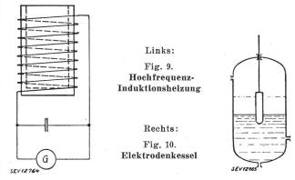
Die Wärmeerzeugung durch Hochfrequenz gelangt auch bei der Oberflächenhärtung von Stahl zur Anwendung. Als hervorstechendste Merkmale der Induktionsheizung im allgemeinen können genannt werden: Geringe Uebertemperatur des Wärmeerzeugers gegenüber dem Schmelzgut. Aeusserst intensive Baddurchmischung, die selbständig erfolgt. Anschluss nur an Wechselstrom möglich. Höchste Anschlusswerte für gegebene Heizflächen.
