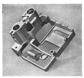
Fig. 1. Chassis aus Spritzguss zu Kleinmotorschutzschalter
