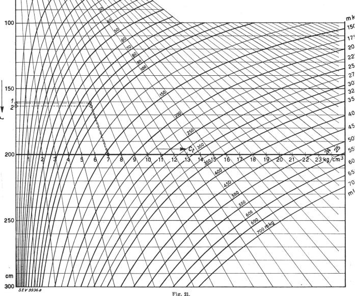
Hilfstafel für die Ermittlung der Fundamenttlefen t. Graphische Darstellung der Gleichung (7).
