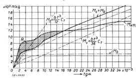
Fig. 18. Graph. Darstellung der Versuchs- und Berechnungsergebnisse Schraffierte Fläche: Reibung (R).
