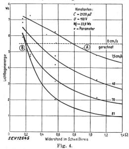
Erwärmungsenergie an der Schweißstelle in Abhängigkeit vom Widerstand des Schweisskreises
