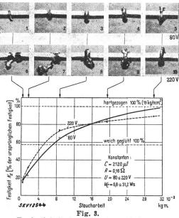
Zugfestigkeit der Schweissverbindung, abhängig von der Staucharbeit
