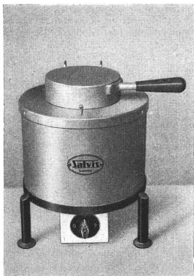
Fig. 2. Elektrischer Kleintiegelofen max. Temperatur 1000° C
