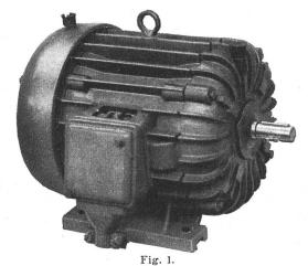
Geschlossener Motor mit Rippengehäuse und Aussenventilation
