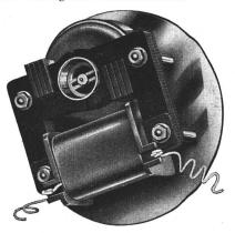
Fig. 1. Moteur synchrone
