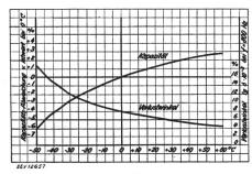
Kapazitäts-Abweichung und Verlustwinkel der STR-Tieftemperatur-Papier-Kondensatoren in Abhängigkeit der Temperatur
