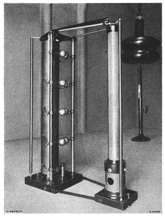
Fig. 2. Stoßspannungsanlage für Industrieprüffeld 500 kV; 1,5 kWs.
