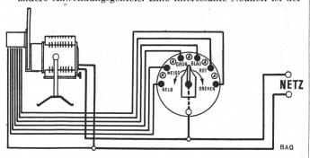
Fig. 2. Prinzipschema des Farbscheinwerfers
