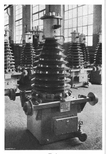
Fig. 1. Messgruppe von 60 kV Nennspannung, 152 kV Prüfsp., 50 Hz Stromwandler 300/5 A; Spannungsw. 50 000/ $\sqrt{3}$  /2×100/ $\sqrt{3}$  V Klasse 0,5
