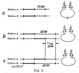
Abhängige Strompause bei zweifacher Einspeisung
