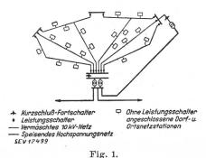
Vermaschtes 10-kV-Netz mit abgehenden Stichleitungen mit zweifacher, verbundener Einspeisung
