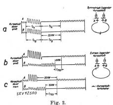
Strompause bei zweifacher Einspeisung
