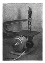
Beschreibung: Kleinsäge gemäss Abbildung, angetrieben durch gekapselten Einphasen-Kurzschlussankermotor mit Hilfsphase. Schalter mit Anlaufstufe angebaut. Netzanschluss mit dreiadriger, mit 2P+E-Stecker versehener verseilter Schnur.
