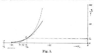
Die kubische Parabel als Dioden-Ersatzkennlinie —  $I=445(U+1,1)^3~\mu$  A; zum Vergleich die e-Funktion: —  $I=12~e^{-10(U+0,8)}~\mu$  A Die gemessenen Werte sind mit Kreisen bezeichnet.
