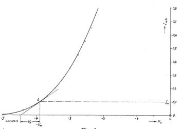
Fig. 6. Die kubische Parabel als Trioden-Ersatzken nlinie  $I=20(U+5,61)^3~\mu\,\mathrm{A}$  Die gemessenen Werte sind mit Kreisen bezeichnet.
