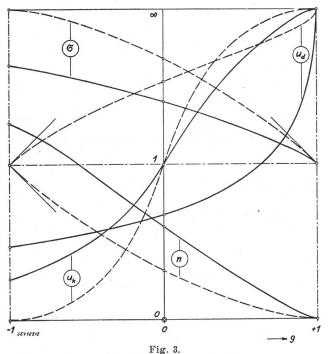
Scheitelspannungskorrekturfaktor σ und Differenzspannungswert ud
