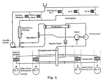
Schema der Wärmepumpen-Anlage
