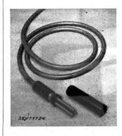
Beschreibung: Moststerilisierapparat gem. Abb., mit 3 Elektroden zum Eintauchen in Flaschen oder Fässer. Elektroden aus Kohle oder rostfreiem Stahl an einem Halter befestigt und mit einer Schutzhülse aus Isolierpreßstoff von 40 mm Aussendurchmesser versehen. Letztere ist beidseitig offen, so dass der Most zirkulieren kann. Elektrodenlänge je nach Betriebsspannung verschieden. Netzanschluss mit anvulkanisierter Gummiaderschnur.
