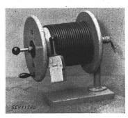
Beschreibung: Kabeltrommel gem. Abb., mit Kontaktvorrichtung. Kontaktvorrichtung für Vor- und Rückwärtslauf in der Kabeltrommel eingebaut und mit der letzteren derart verriegelt, dass das Kabel nur bei ausgerückter Kontaktvorrichtung auf- und abgerollt werden kann (der Erdkontakt wird nicht unterbrochen). Kugelgriff aus Isolierpreßstoff für die Betätigung der Kontaktvorrichtung. Spulenkern von 200 mm Durchmesser aus Eisenblech, Spulenflansche aus Holz.
