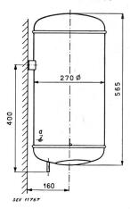
Beschreibung: Elektrischer Heisswasserspeicher gemäss Skizze für Wandmontage. Zwei Heizelemente und Temperaturregler mit Sicherheitsvorrichtung eingebaut. Netzanschluss mit dreiadriger, mit Stecker versehener Gummiaderschnur.
