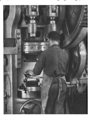
Fig. 2. Ziehvorgang eines Gehäuseoberteils aus Aluminium
