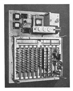
Fig. 2. Relaiszentrale 1/10 Abmessungen:  $740 \times 590 \times 240$  mm Gewicht: 50 kg
