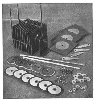
Fig. 2. Selen-Gleichrichter-Element und Selen-Gleichrichter-Bestandteile
