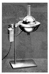
Fig. 1. Elektrische Heizkalotte
