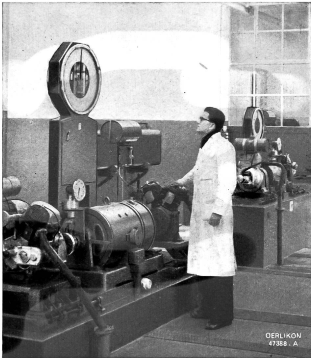
Fig. 2. Prüfstand für Wärmekraftmaschinen, ausgerüstet mit Leistungswaagen
