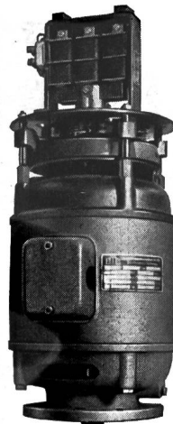
Fig. 2. Dreigeschwindigkeits- Kurzschlussanker-Flanschmotor für vertikale Montage mit aufgebaute elektromagnetischer Bremse
