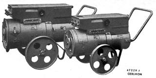
Fig. 4. Schweissumformergruppen für Schweißströme 15...350 A
