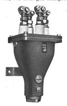
Fig. 3. Druckfester Kabelendverschluss für Vertikal- oder Horizontalmontage Al- oder Cu-Kabel 4 · 35 mm<sup>2</sup>
