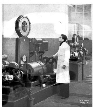
Fig. 2. Prüfstand für Wärmekraftmaschinen, ausgerüstet mit Leistungswaagen
