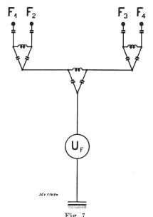
Messung der mittleren Erdspannung der vierdrähtigen Fahrleitung
