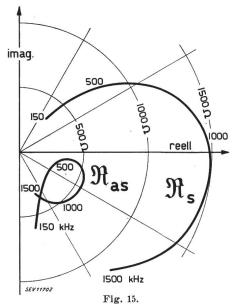
Widerstand des beschalteten Fahrzeuges, von der Fahrleitung
