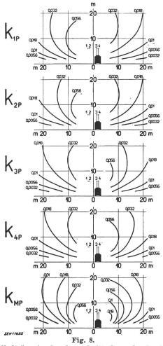
Potentialbeiträge in der Querschnittsebene durch eine zweispurige Anlage mit Fahrzeug
