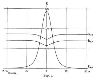
Potentialbeiträge in einem Fixpunkt P auf Fahrdrahthöhe bei ca. 6 m Abstand, in Funktion des Fahrzeugstandortes auf einer einspurigen Anlage
