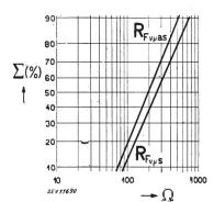
Fig. 3. Summen-Häufigkeit der symmetrischen und asymmetrischen Widerstandswerte des Fahrdrahtpaares  $F_{\mathcal{V}}$   $F_{\mathcal{U}}$
