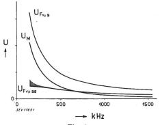
Fig. 4. Störkennlinien der Trolleybusanlage
