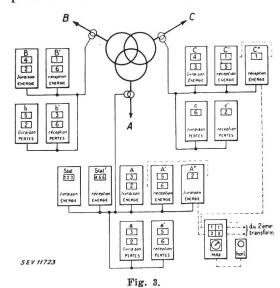
Schéma de principe complet de l'un des transformateurs Les chiffres inscrits dans les cadrans indiquent les régimes pour lesquels ces cadrans enregistrent la quantité d'énergie fournie ou reçue par le circuit correspondant.
