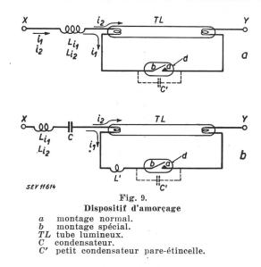
filaments des deux électrodes du tube TL reste seule en série avec la self-induction, elle est très petite; le courant est donc assez intense et les électrodes sont portées à l'incandescence. Pendant
