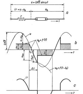
Fig. 1. Stabilisation par résistance ohmique
