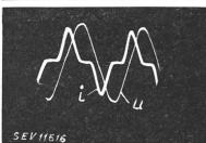
Fig. 11: La fréquence de résonance est légèrement supérieure à 100 Hz
