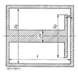
Fig. 2. Schnitt durch einen unsymmetrischen Schwingtopf
