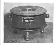
Beschreibung: Elektrischer Heizofen gem. Abb. Widerstandsspirale in Ring aus Tonrohr eingezogen und in ventiliertes Blechgehäuse eingebaut. Apparatestekker angebaut.
