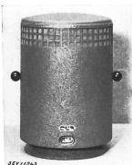
Beschreibung: Heizofen mit Ventilator gemäss Abbildung. Oben in einem Blechzylinder befindet sich eine Widerstandsspirale. Darunter ist ein Ventilator angebracht, welcher durch einen Einphasen-Kurzschlussankermotor angetrieben wird. Eine Temperatursicherung unterbricht den Stromkreis, soinfolge ungenügender bald Ventilation zu hohe Temperaturen auftreten. Die Luft wird unten durch ein Filter angesaugt und oben seitlich ausgeblasen. Apparatestecker für den
