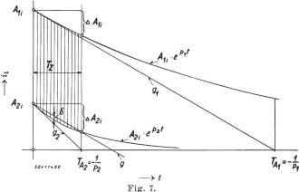
Ladestrom  $i_1$  des Zeitkondensators (schraffiert) während Laufzeit über die Zeitaxe  $T_z$  , unter Ausnützung des Zeitintervalls  $T_z=-\frac{1}{-}$
