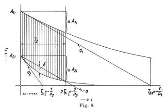
Ladestrom  $i_1$  des Zeitkondensators (schraffiert) während Laufzeit über die Zeitaxe  $T_z$  unter Ausnützung des Zeitintervalls  $T_z = -\frac{2}{-}$
