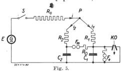
Schema der wiederholten linearen Zeltablenkung mit Entladefunkenstrecke  $F_{\circ}$  und Mitnehmerfunkenstrecke  $F_{\mathsf{m}}$  als Schaltorganen
