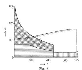
Einschaltung des Wärmepumpen-Ergänzungswerkes in die Wärmewirtschaft des Fernheizkraftwerkes der ETH, Zürich A Täglicher Wärmebedarf in 10° kcal. t Zeit in Tagen.
