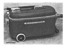
Beschreibung: Elektrischer Großstaubsauger gemäss Abbildung. Zweistufiges Zentrifugalgebläse, angetrieben durch Einphasen-Seriemotor. Motoreisen vom Gehäuse isoliert. Apparat mit Schlauch, Führungsrohren und verschiedenen Mundstücken zum Saugen und Blasen verwendbar. Filter mit Schüttelvorrichtung.
