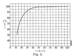
Prozentualer Anteil einer Wärmepumpe an der jährlich von der Heizanlage erzeugten Wärmemenge
