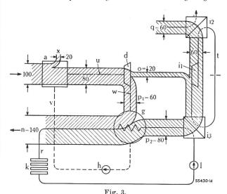
Wärmepumpe mit Dampfturbinenantricb in einem Fernheizwerk
