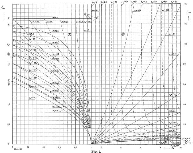
Zeitpunkte des Spannungsmaximums in Abhängigkeit von  $\alpha_0$   $\beta_0$  und  $\delta_0$  (relative Werte  $\vartheta_m$  und  $\theta_m$ ).
