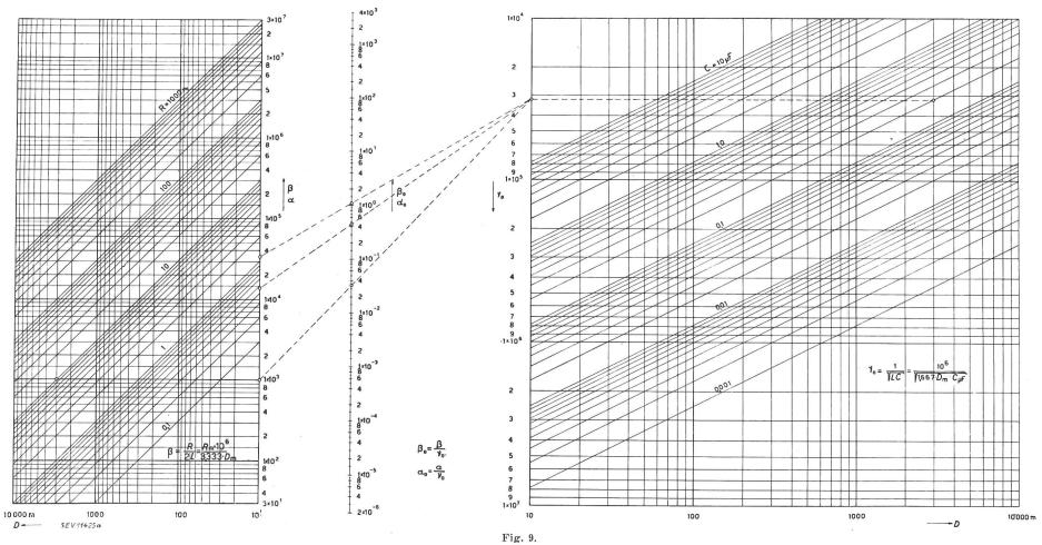
Nomogramm zur Bestimmung der Parameter  $\nu_0,\,\beta,\,\alpha_0$  und  $\beta_0$  ( $\dot{c_0}=\beta_0-\alpha_0$ )
