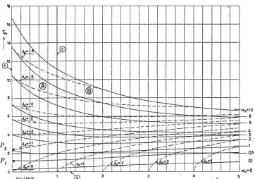
Für die relative maximale Spannung  $u_{max}/e_s$  wird am besten  $\delta_0$  als Abszisse und  $u_{max}/e_s$  als Ordinate angenommen mit  $\alpha_0$  und  $\beta_0$  als Parameter. Man erhält damit ein Netz krummliniger Koordina-
