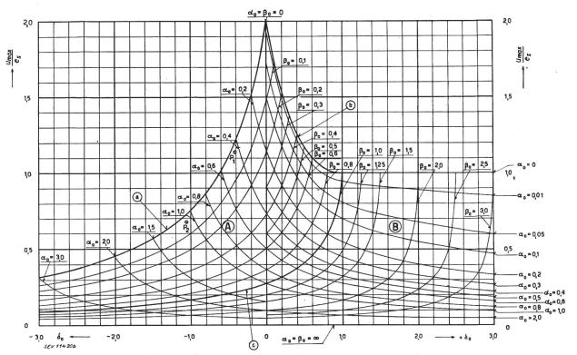
Fig. 6a: Spannungswerte im Abzissenintervall  $-3 < \delta_0 < +3$ Spannungsmaximum an der Kapazität in Abhängigkeit von  $\alpha_0$ ,  $\beta_0$  und  $\hat{c_0}$ . Legende für alle 3 Bilder:
