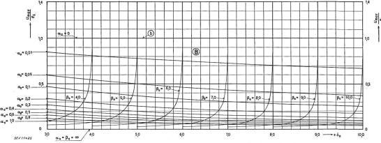
Fig. 6c: Spannungswerte im Abszissenintervall  $+3 < \hat{c_0} < +10$
