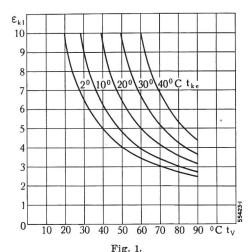
Leistungsziffern von Heizmaschinen grosser Leistung für Heisswassererzeugung mit Umweltwasser verschiedener Temperatur als Wärmequelle (Kaltdampf-Wärmepumpen mit Turbokompressor als Verdichter)
