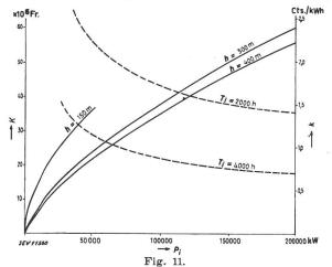
Baukosten und Energiegestehungskosten von Hochdruckwerken ohne Speicherung
