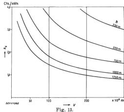
Durchschnittliche Speicherungskosten pro gespeicherte kWh in Abhängigkeit vom nutzbaren Stauvolumen k. Speicherungskosten. V Nutzbares Stauvolumen. h Gefälle.
