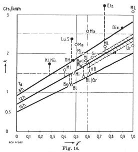
Durchschnittliche Erzeugungskosten und Wert der verfügbaren Akkumulierenergie ab Kraftwerk
