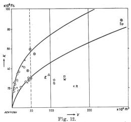
Baukosten von Staubecken in Abhängigkelt von nutzbaren Stauvolumen K Baukosten. V Nutzbares Stauvolumen. Kraftwerke bzw. Staubecken:
