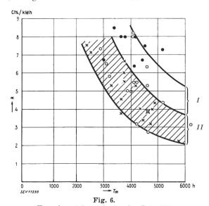
Energiegestehungskosten im Jahr 1936 in Abhängigkeit von der Gebrauchsdauer der Maximalleistung
