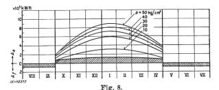
Theoretische Möglichkeiten der Erzeugung elektrischer Energie im Gegendruckbetrieb im Krankenhaus X
