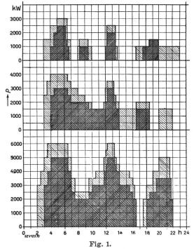
Leistungsdiagramme der Elektrodampfkesselanlage im Krankenhaus X
