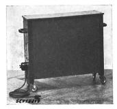
Beschreibung: Elektrischer Heizofen gemäss Ab-bildung. Zwei Heizwiderstände auf keramische Körper gewickelt und in Eternitgehäuse eingebaut. Angebauter Schalter ermöglicht den Betrieb des Ofens mit der halben und ganzen Heizleistung. Netzanschluss mit zweiadriger, mit Stekker versehener verseilter Schnur.
