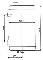
Beschreibung: Heisswasserspeicher gemäss Skizze für Wandmontage. Zwei Heizelemente und ein Temperaturregler mit Sicherheitsvorrichtung von oben her eingeführt.
