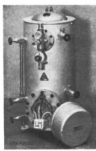
Beschreibung: Heisswasserspeicher gemäss Abbildung, für Kaffeemaschinen-Grossanlagen. Schaltschütz, durch Druckreg-ler gesteuert. Der Speicherbehälter arbeitet mit zirka 0,5 kg/cm<sup>2</sup> Ueberdruck, es kann daher Wasser von Siedetemperatur bzw. Wasserdampf entnommen werden. Der Heisswasserspeicher wird in einen Kasten eingebaut, auf welchem sich die Einrichtungen für die Zubereitung von Kaffee u. dgl. befinden.
