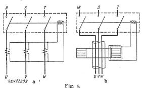
Die Differentialschutzschaltung in Verbindung mit Stromwandlern
