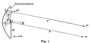
Im Brennpunkt eines Parabolspiegels befinde sich ein erregender Dipol, der eine linear polarisierte Kugelwelle aussendet. Die Feldstärke im Abstand  $\varrho$  unter dem Winkel  $\vartheta$  mit der Spiegelachse ist
