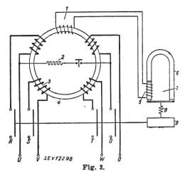
Schema eines vierpoligen Differentialschutzschalters mit eingebauter Prüfeinrichtung
