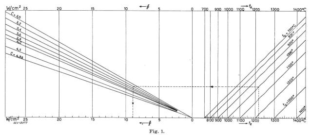
Nomogramm für  $\phi = C(T_0^4 - T_0^4) = C[(t_0 + 273)^4 - (t_0 + 273)^4]$
