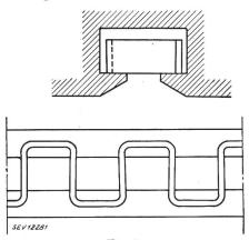
Fig. 5. In Nute verlegtes gewelltes Bandelement
