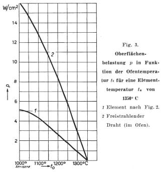
Auf die gleiche Weise kann man für den angeführten Fall die Oberflächenbelastung berechnen, welche eine Elementtemperatur von 1350° C ergibt,
