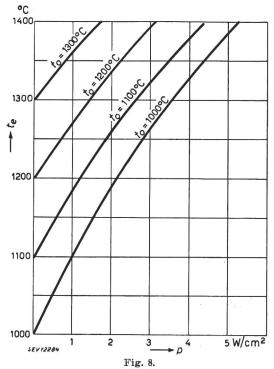
Die Elementtemperatur  $t_0$  bei Ausführung nach Fig. 6 in Funktion der Oberflächenbelastung p und der Ofentemperatur  $t_0$
