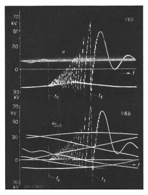
Fig. 2. Oszillogrammbeispiel der Abschaltung eines 2500-kVA-Transformators aus dem Einphasenbetrieb bei 16 kV, 16% Hz, nach dem Schema Fig. 1
