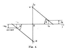
Grundsätzlicher Verlauf der Lichtbogen-Charakteristik des Schalters Sch
