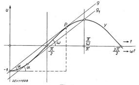
Fig. 9. Graphische Bestimmung der minimal erforderlichen Schalterfestigkeit  $v_{\min}$  als Tangente g mit der Neigung  $\alpha:\omega\simeq 0,725$
