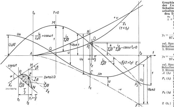
Fig. 8. Graphische Berechnung der Ueberspannung am Schalter Sch beim Ab-schalten des leerlaufen-
