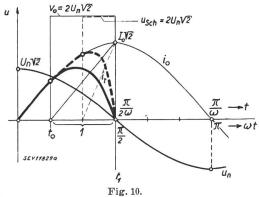
Verlauf des Stromes  $i_T$  im Transformator bei dessen Abschaltung aus dem Leerlauf (Strom  $i_0$ ), unter Voraussetzung der Löschung im Moment  $u_n = \emptyset$ , und unter Annahme:
