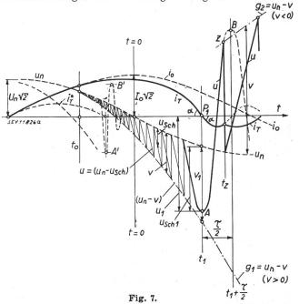
Stilisiertes Oszillogramm der Abschaltung, mit Bezeichnungen  $u_{n_i}$   $u_{\text{Sch}}$ , u Spannung am Netz, am Schalter, am Transformator.  $i_{7}$ ,  $i_{6}$  Wirklicher Strom und Leerlaufstrom. Elektrische Festigkeit des öffnenden Schalters. Stromverlauf und Spannungsextreme im Fall der Löschung vor  $i_{0\text{max}}$  bzw.  $u_{n}=0$  (strichliert).
