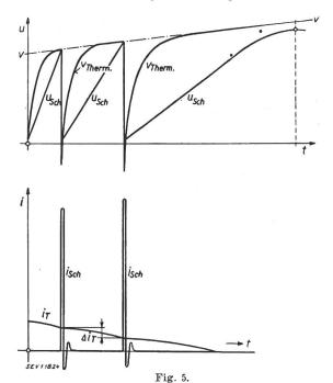
Verlauf der elektrischen Festigkeit v des Schalters und der wiederkehrenden Spannung  $u_{\mathsf{Sch}}$
