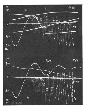
Fig. 6. Oszillogrammbelspiel mit deutlichem Ausschwingen des Transformators T mit seiner Zuleitungskapazität  $C_1$ , nach dem Abschalten des Transformators aus dem Einphasenbetrieb 16 kV, 16% Hz nach Fig. 1
