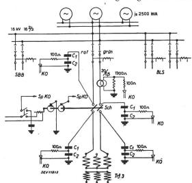
Fig. 11. Prinzipschema der Versuche in der Einphasenstrom-Bahnanlage 16 kV, 16% Hz
