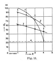
Fig. 13. Häufigkeit verschieden hoher Abschalt-Ueberspannungen am Transfor-mator im Einphasennetz 16 kV, 16% Hz
