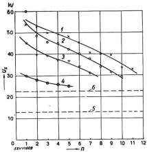
Fig. 7. Häufigkeit verschieden hoher Abschalt-Ueberspannungen am Drehstrom-Transformator bei 16,5 kV Betriebsspannung, 50 Hz
