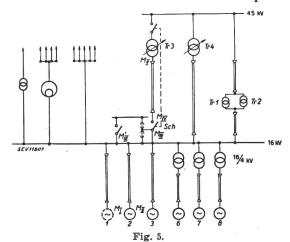
Prinzipschema der Versuche in der Drehstromlage 16 kV, 50 Hz
