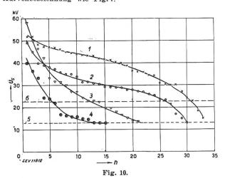
Häufigkeit verschieden hoher Abschalt-Ueberspannungen über den öffnenden Schalterpol, bei Drehstrom 16,5 kV, 50 Hz n Anzahl Ueberspannungen aller drei gemessenen Phasen, die den Ordinatenwert erreichten oder überstiegen.
