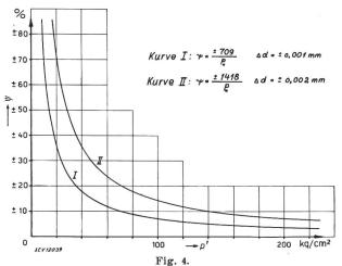
$\Psi$ -Werte in Funktion der Pressung p', d. h. des Gefälles H
