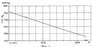
Fig. 5. . . Normaler Barometerdruck  $(H_a)$  in Funktion der Höhe über Meer
