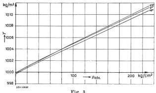
Das spezifische Gewicht von Wasser ( $\gamma$ ) in Funktion des absoluten Druckes  $p_{abs}$  und der Temperatur
