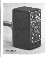
Beschreibung: Eintauch-Temperaturregler gemäss Abbildung, mit einpoligem Umschalter, der durch die Längenänderung des Eintauchstabes betätigt wird. Der Umschalter mit Silberkontakten weist Momentschaltung auf. Kontaktteile auf keramischem Material angebracht. Plombierbare Kappe aus Isolierpreßstoff.
