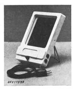
Beschreibung: Rasierspiegel gemäss Abbildung, mit elektrischer Beleuchtung und eingebauter Steckdose zum Anschluss eines Trockenrasierapparates. Gehäuse aus weissem Isolierpreßstoff. Kleine 25-W-Röhrenlampe hinter Opalglasscheibe angeordnet. Einpoliger Druckknopfschalter und zweipolige 6-A-Steckdose eingebaut. Netzanschluss durch zweiadrige Rundschnur mit Stecker 2 P oder 2 P + E.
