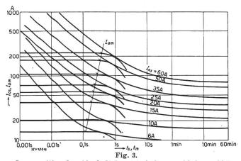
Superposition der Abschaltcharakteristik verschiedener Sicherungen mit den Anlaufcharakteristiken verschiedener Motoren für eine Anlaufzeit von einer Sekunde
