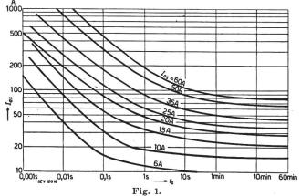
Abschaltcharakteristiken von genormten Flinksicherungen (untere Umhüllende der Streubänder), nach Messungen der Technischen Prüfanstalten des SEV, Abt. MP.
