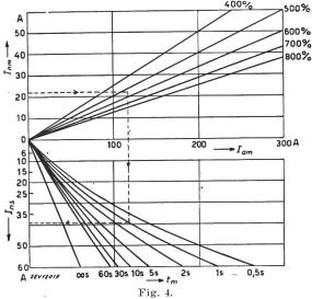
Diagramm zur Bestimmung der kleinstzulässigen Flinksiche-rungen für Kurzschlussankermotoren bei direktem Einschalten
