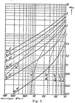
$w_{\min}$  nach Gl. (11b) und (13b) aufgetragen als Funktion von  $a^2$  mit  $\varnothing$  (in Figur  $\varphi$ ) als Parameter Ausgezogene Kurven beziehen sich auf den Fall, dass keine Verstimmung des Eingangskreises benutzt wird (C=0), gestrichelte Kurven hingegen auf den Fall, dass die Verstimmung des Eingangskreises möglichst günstig gewählt wird.
