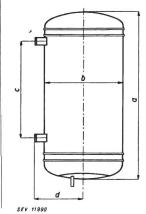
Beschreibung: Heisswasserspeicher gemäss Skizze für Wandmontage. Ein bzw. zwei Heizelemente und Temperaturregler mit Sicherheitsvorrichtung eingebaut. Prüf-Nr. 2 mit Thermometer ausgerüstet.
