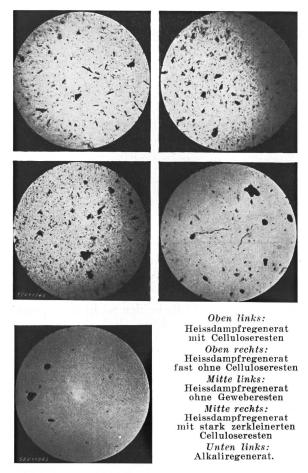
Fig. 36. Mikroaufnahmen von Kautschukregeneraten
