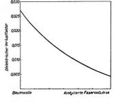
Abhängigkeit des dielektrischen Verlustfaktors vom Azetylierungsgrad der Fasercellulose (bei 1000 kHz)
