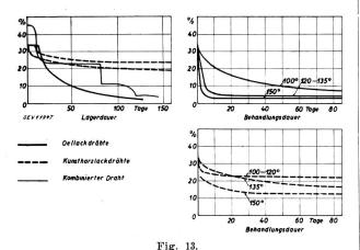
Einfluss verschiedener Drahtlacke auf Aluminiumdrähte Links oben: Abhängigkeit der Wickelfähigkeit von der Lackzusammensetzung.
