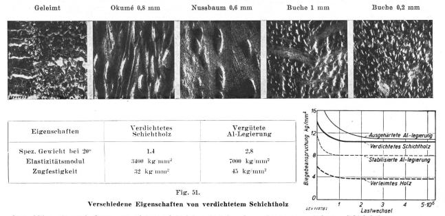
Oben: Mikrogefügeaufnahmen von geleimtem Schichtholz (links) und verschiedenen verdichteten Schichthölzern.
