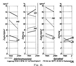
Mechanische Eigenschaften von Transformerboard  $Links\colon$ im Anlieferungszustand nach 72<br/>stündiger Lagerung in 65 % rel. Luftfeuchtigkeit.
