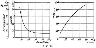
Zusammenhang zwischen der Faserdicke und der Zugfestigkeit von Glasfasern (links); Zusammenhang zwischen der Verknotbarkeit und der Dicke von Glasfasern (rechts)
