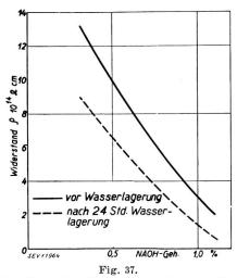
Abhängigkeit des Isolationswiderstandes von Kautschuk-Alkaliregenerat vor und nach der Lagerung in Wasser
