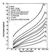
Feuchtigkeitsaufnahme verschiedener Faserstoffe in Abhängigkeit von der relativen Luftfeuchtigkeit
