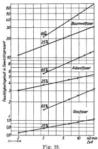
Feuchtigkeitsaufnahme von Asbest-, Baumwoll- und Glasfasern in Abhänglgkeit von der Zeit
