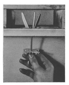
Fig. 5. Montieren der Pendel-Aufhängung
