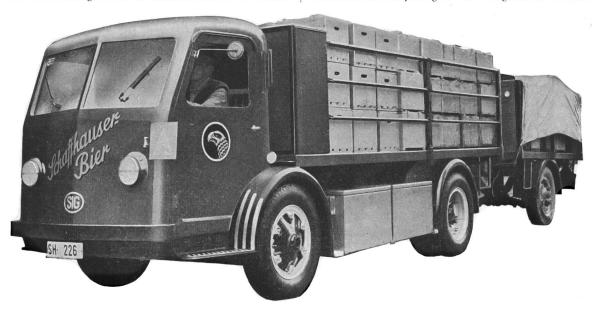
Fig. 1. Akkumulatorenfahrzeug der SIG
