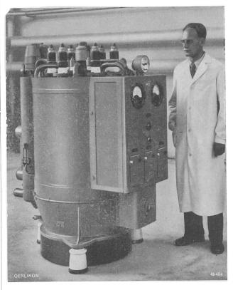
Fig. 2. Luftgekühlter Gleichrichter 1000 A, 600 V
