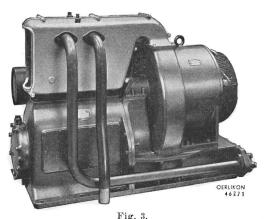
Lokomotiv-Kompressor Fördermenge 4000 l/min, Enddruck bis 10 kg/cm².
