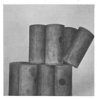
Fig. 2. Nach dem Elin-Hafergut-Verfahren geschweisste Zylinder
