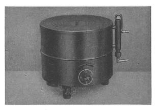
Fig. 2. Elektrisches Wasserbad
