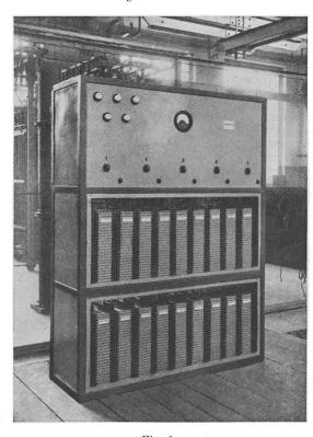
Fig. 2. Automatisch gesteuerte Kondensatorregelbatterie 200 kVar, 540 V, 3  $\sim$  50, mit Blindleistungsregler Landis & Gyr.
