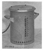
Beschreibung: Tragbarer, luftgekühlter Schweisstransformator in Blechgehäuse gemäss Zwei getrennte Abbildung. Wicklungen. Sekundärwicklung mit Anzapfungen für 9 Schweißstufen von 15...150 A. Netzanschluss mit dreiadriger Apparateschnur.
