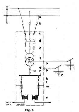
Schema der fahrbaren Transformatorenstation
