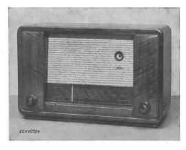
Beschreibung: Kombinierter Radio- und Telephonrundspruchapparat gemäss Abbildung. Apparat für den Empfang langer, mittlerer und kurzer Wellen, ferner für niederfrequenten Telephonrundspruch und Grammophonverstärkung. Lautstärkeregler, Klangregler und Programmwähltaste vorhanden. Anschluss eines zweiten Lautsprechers möglich.
