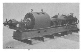
Fig. 1. 220-kW-Dampfturbine aus dem Jahre 1901 (Fabrikationsnummer 8 von Brown Boveri)
