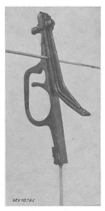
Fig. 4. Kontaktzange an der Hochspannungsleitung
