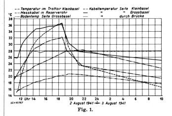
Nach den Angaben des VDE beträgt die zulässige Erwärmung im Dauerbetrieb für Hochspannungskabel 25°C; die VDE-Tabelle gibt hierfür als extrapolierten Wert bei der Verlegung im Erdboden 250 A an. Auf Grund der an der Augster Leitung durchgeführten Versuche ergibt sich ein Temperaturgefälle zwischen Leiter und Bleimantel von 7°C bei 200 A Belastung. Die Uebertemperatur von 25°C wird somit erreicht:
