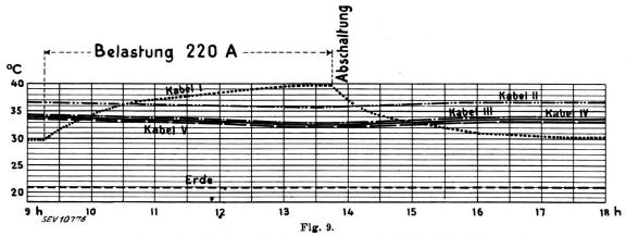
Aufzeichnung der Kabel- und Bodentemperaturen durch Registrier-Instrument
