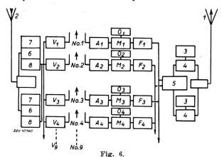
Vielfach-Telephonie-Verbindung Schottland-Irland Sprechkanälen. — Blockschema des Sender-Empfängers
