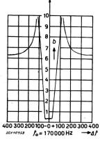
Fig. 5. Durchlasskurve eines Kristallfilters
