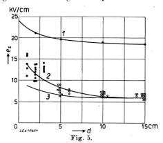
Mittlere spez. Festigkeit (e<sub>s</sub>) von Luft bei Wechselspannung von Industriefrequenz in Funktion der Schlagweite (d)
