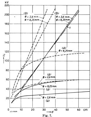
Elektrische Festigkeit zwischen parallelen Drähten oder Zylindern in Funktion der Schlagweite für verschiedene Drahtdurchmesser
