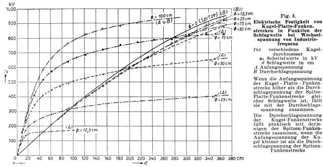
Abrundungen resp. Kugeln an den Elektroden können die Festigkeit erhöhen. Es fragt sich, wie weit dies in der Praxis zur Erhöhung der Elastizität herangezogen werden kann. Hierüber gibt Fig. 3 Auskunft 51). Für eine gegebene Schlagweite erhöht eine
