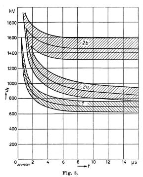
Koordination eines Stützisolators, dessen Stossfestigkeit von der Polarität des Stosses ähnlich wie die Stab-Platte-Funkenstrecke stark abhängig ist, mit einer polaritätsunabhängigen Stab-Stab-Funkenstrecke
