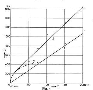
50%-Stossfestigkeit von Kugel-Platte- und Spitze-Platte-Fun-kenstrecken beim Stoss 1,5/40 μs in Funktion der Schlagweite u<sub>s</sub> Scheitelwerte, in kV d Schlagweite, in cm
