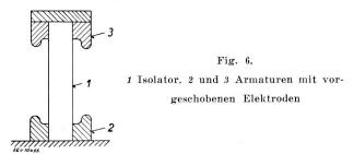
Die Festigkeit zwischen zwei parallelen Drähten ist ebenfalls erheblich höher als zwischen Spitzen. Bei deren Messung müssen die Drähte abgebogen werden, damit die Enden nicht als Spitzen wirken. Die Drähte könnten auch in Ringe geschlossen werden, so dass sie keine Enden besitzen. Dieses Vorgehen wäre konstruktiv verwendbar, wenn die Armaturen so ausgebildet würden, wie Fig. 6 andeutet.
