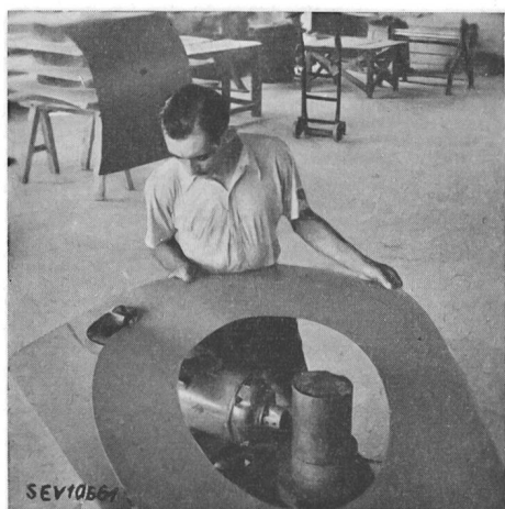
Fig. 1. Ausschneiden von Preßspan mit Blechschere
