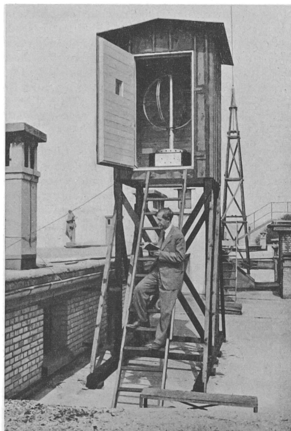
Die Antennen des Goniographen auf dem Dach der Meteorologischen Zentralanstalt in Zürich
