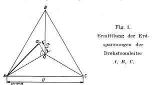
effektive Wert der Erdspannung des Phasenleiters A ermittelt ist. Zur Schwerpunktspannung  $\overline{AO}$  dieses Leiters ist die Nullpunktverlagerung  $U_2$  rechtwinklig zu addieren. Man kommt so zu Punkt O' und in  $\overline{AO'}$  zum effektiven Wert der Erdspannung des Leiters A. Die Konstruktion kann für Drehstromsysteme nur nacheinander an jedem Leiter
