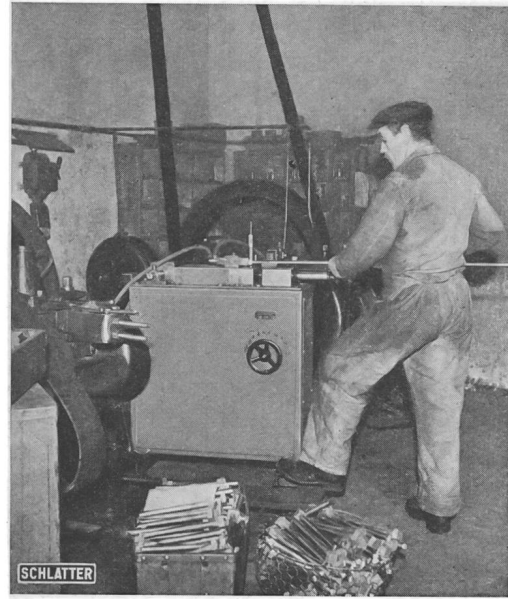
Fig. 8. Maschinen zum Wärmen von Bolzen zur Herstellung von Vierkant-Köpfen
