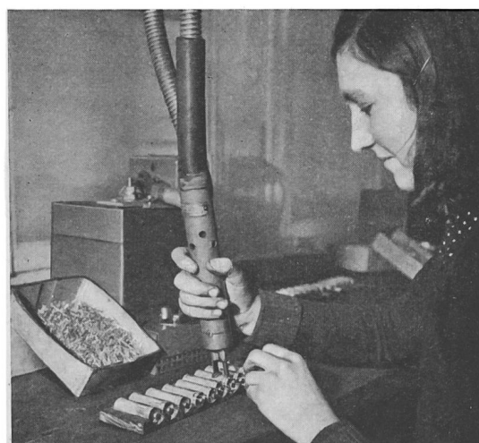
Fig. 25. Schweissen mit Kohlestift von Taschenlampenbatterien
