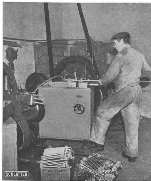
Fig. 8. Maschinen zum Wärmen von Bolzen zur Herstellung von Vierkant-Köpfen
