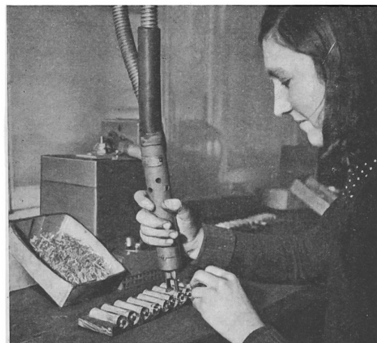
Fig. 25. Schweissen mit Kohlestift von Taschenlampenbatterien
