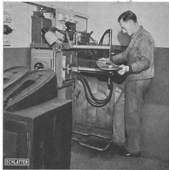
Fig. 18. Anpunkten von Bestandteilen an Kettenschutzkästen für Fahrräder
