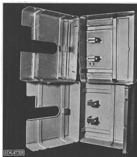
Fig. 19. Nähmaschinenkasten mit ca. 250 Punktschweissungen
