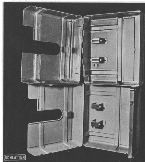
Fig. 19. Nähmaschinenkasten mit ca. 250 Punktschweissungen
