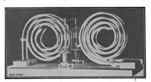
Fig. 19. Versuchs-Oszillator mit spiralförmig «aufgewickelten» Stabsystemen
