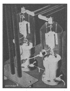
Fig. 18. Versuchsanordnung: Zweiröhren-Oszillator mit Parallelstäben als Schwingsystemen
