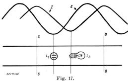
Lechersche Drähte mit «stehenden Wellen» Verteilung von Strom I und Spannung E
