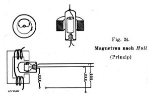
im Kreise rotierend vorstellen möge 5). Die Frequenz ist abhängig von der Dimensionierung der Röhre, von der angelegten Anodenspannung und der Stärke des Magnetfeldes; die beiden letztgenannten Faktoren müssen somit konstant gehalten werden, da sonst eine Frequenzänderung auftritt. Anderseits kann jedoch z.B. durch Modulierung der Anodenspannung eine Frequenzmodulation erreicht werden.
