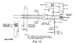
Schaltung eines Oszillators für 50 cm Wellenlänge mit der Röhre Western 316 A
