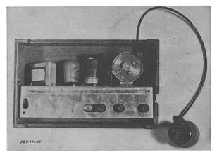
Fig. 10. HF-TR-Zusatzkästchen, Rückansicht offen
