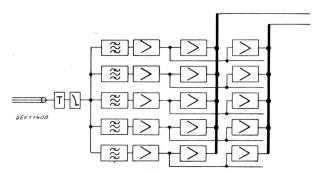
Fig. 6. Kanalverstärker (Prinzipschema)
