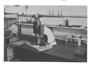
Fig. 11. Elektrisch geschweisste Presse in halbfertigem Zustand
