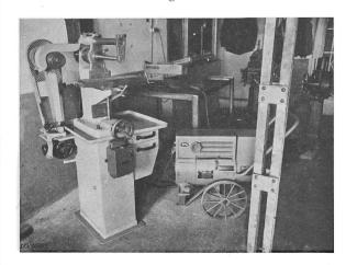
Fig. 10. Elektrisch geschweisste Fräse
