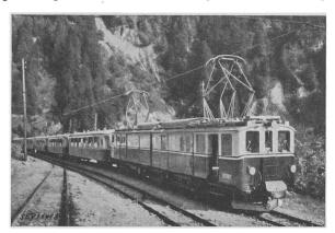
Fig. 12. Schnellzug der Montreux-Berner Oberland-Bahn (Gleichstrom 750...1000 V)
