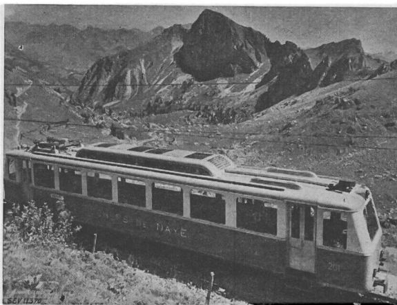
Fig. 39. Triebwagen der Zahnradbahn Glion-Rochers de Naye (Spurweite 800 mm, Gleichstrom 800 V)
