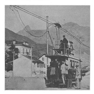
Fig. 2. Motorwagen der ersten elektrischen Strassenbahn der Schweiz aus dem Jahre 1888, mit zweipoliger Schlitzrohr-Fahrleitung (siehe Fig. 3) (Linie Vevey-Montreux-Chillon)
