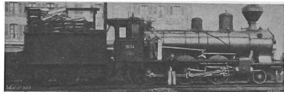
Fig. 24. Dampflokomotive der Serie B 3/4 der SBB mit Holzfeuerung im Jahre 1919
