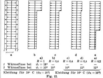
Schematische Darstellung des Körper-Wärmeflusses für verschiedene relative Beheizungsziffern R und Raumtemperaturen  $\vartheta_r$
