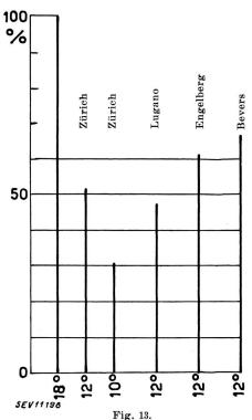
Nötige Wärmemenge für die Grundheizung auf 12° (für Zürich auch 10°), in % der Wärmemenge für normale Heizung (18°) für 4 ungleich hoch gelegene Orte der Schweiz, bestimmt nach den Temperaturhäufigkeiten 1869...1929.
