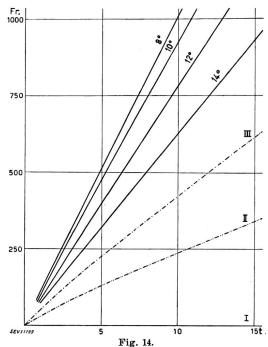
Diagramm der mit Individual-Zusatzhelzung erreichten Ein-sparung in Funktion der Koksmenge
