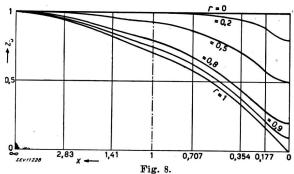
Anoden-Abblockung: Frequenzcharakteristiken  $z_a = F(x)$
