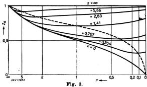
Parallel-Tonblende: Regelcharakteristiken z<sub>s</sub> = F (r) (Gestrichelte Kurve: Ort der Minima)
