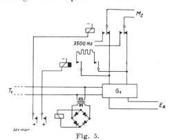
in der Endausrüstung für ein drahtloses Vielfachtelephonieteilstück, wie beim Drahtweg, am Verstärker vor der Gabel über einen Transformator abgenommen und gleichgerichtet. Die so erhaltenen Impulse steuern ein Relais, das 3500 Hz auf den Gesprächskanal bringt. Auf der Empfängerseite
