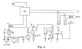
Drahtlose Vielfachtelephonie, Impulsweg empfängerseitig.  $T_2$  Teilnehmer 2.  $G_2$  Gabel 2.  $M_Z$  zur Modulation des Zwischenträgers.  $E_{\mathsf{E}}$  Empfänger-Endstufe. A Relais für ankommende Impulse. B Korrekturrelais. C Senderelais.
