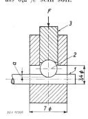
Fig. 2. Prüfeinrichtung für den Nachweis des Fliessens des Leitermetalls.
