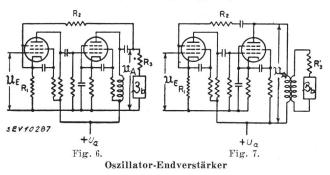
Eine Berechnung für das Schaltschema Fig. 6 fordert für maximale an die Belastungsimpedanz  $\beta_b$  gelieferte Leistung
