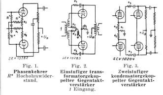
nungen ruft Unabgeglichenheit einen Strom durch den Widerstand  $R_1$  hervor, der die zentrierende Gegenkopplungsspannung erzeugt.  $R_2$  und  $R'_2$  bewirken die normale Gegenkopplung, die durch  $R_3$  und  $R'_3$  geregelt werden kann.
