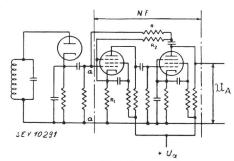
Fig. 11. **Dioden-Entzerrung**NF NF-Verstärker.
