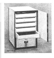
Beschreibung: Elektrischer Dörrapparat gemäss Abbildung. Gestell Eisen, Verschalung aus Lignat. Fünf Hurden mit Drahtgitter. Apparatestekker für den Anschluss der Zuleitung.
