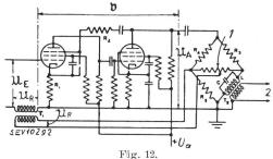
Frequenzabhängige Gegenkopplung mit Brücke v Verstärkungsfaktor. 1 Regelung der Resonanzschärfe. 2 Transformator-Ausgang.
