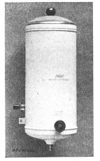
Beschreibung: Kleiner Heisswasserspeicher für Wandmontage gemäss Abbildung, mit einem Nutzinhalt von ca. 5 l. Das Wasser muss oben eingefüllt werden. Heizelement und Temperaturregler mit Temperatursicherung unten eingebaut. Apparatestecker für den Anschluss der Zuleitung.
