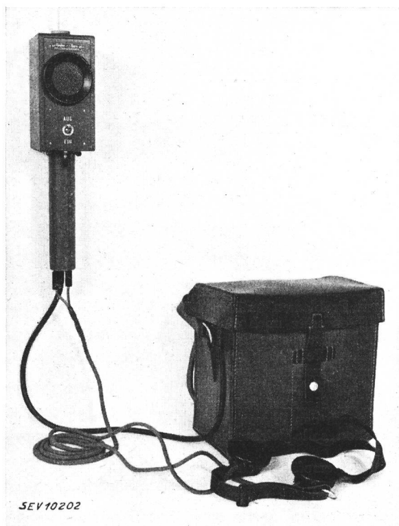
Fig. 2. UKW-Telephonie-Gerät für ca. 1,8 m Wellenlänge.
