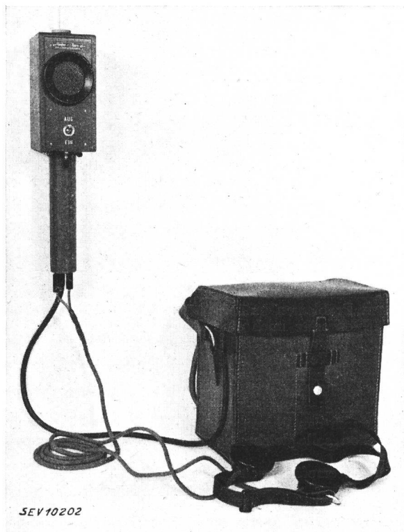
Fig. 2. UKW-Telephonie-Gerät für ca. 1,8 m Wellenlänge.
